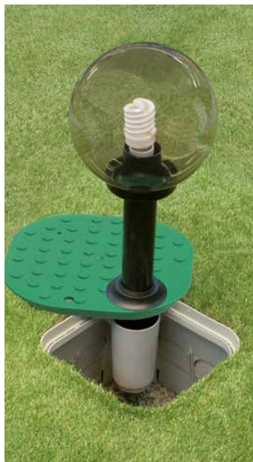
Forando il coperchio con una sega a tazza ed usando l'articolo PBR60 si possono installare pali Ø 60 mm per corpi illuminanti
