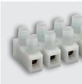
Materiali utilizzati: viti in acciaio zincato e guscio in poliammide. Temperatura d'esercizio da -30 a +110°C Resistenza al calore + 150°C Utilized materials: screws of zinc plated steel and shell of polyamide. Working temperature from -30 to +110°C Heat resistance + 150°C
