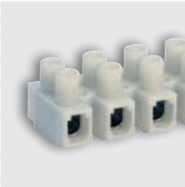
Materiali utilizzati: viti ed inserto in acciaio zincato, guscio in polipropilene. Temperatura d'esercizio da -5 a +85°C Resistenza al calore + 130°C Utilized materials: screws and inserts of zinc plated steel, shell of polypropylene. Working temperature from -5 to +85°C Heat resistance + 130°C
